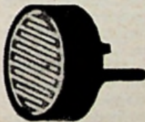
Fotocel van „Radio-Industrie“ met 1000-voudig verhoogde gevoeligheid. 1 A per Lumen.
